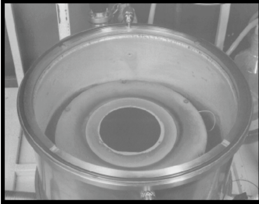
Abbildung (40): Blick in den Reaktionsofen bei heruntergenommenem Deckel und Gasführungssystem. Die dunkle Scheibe im Zentrum ist das Siliziumsubstrat auf der Quarzplatte.
