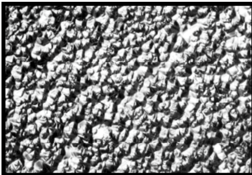
Abbildung (49): Polykristallin gewachsenes Kristallmaterial, meistens im Randbereich der Scheibe. Die Bilddiagonale entspricht ca. 500 \mu\text{m} .
